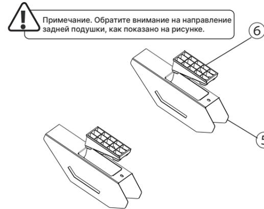
Соедините заднюю подкладку для ног (6) и декоративную металлическую пластину (5).
